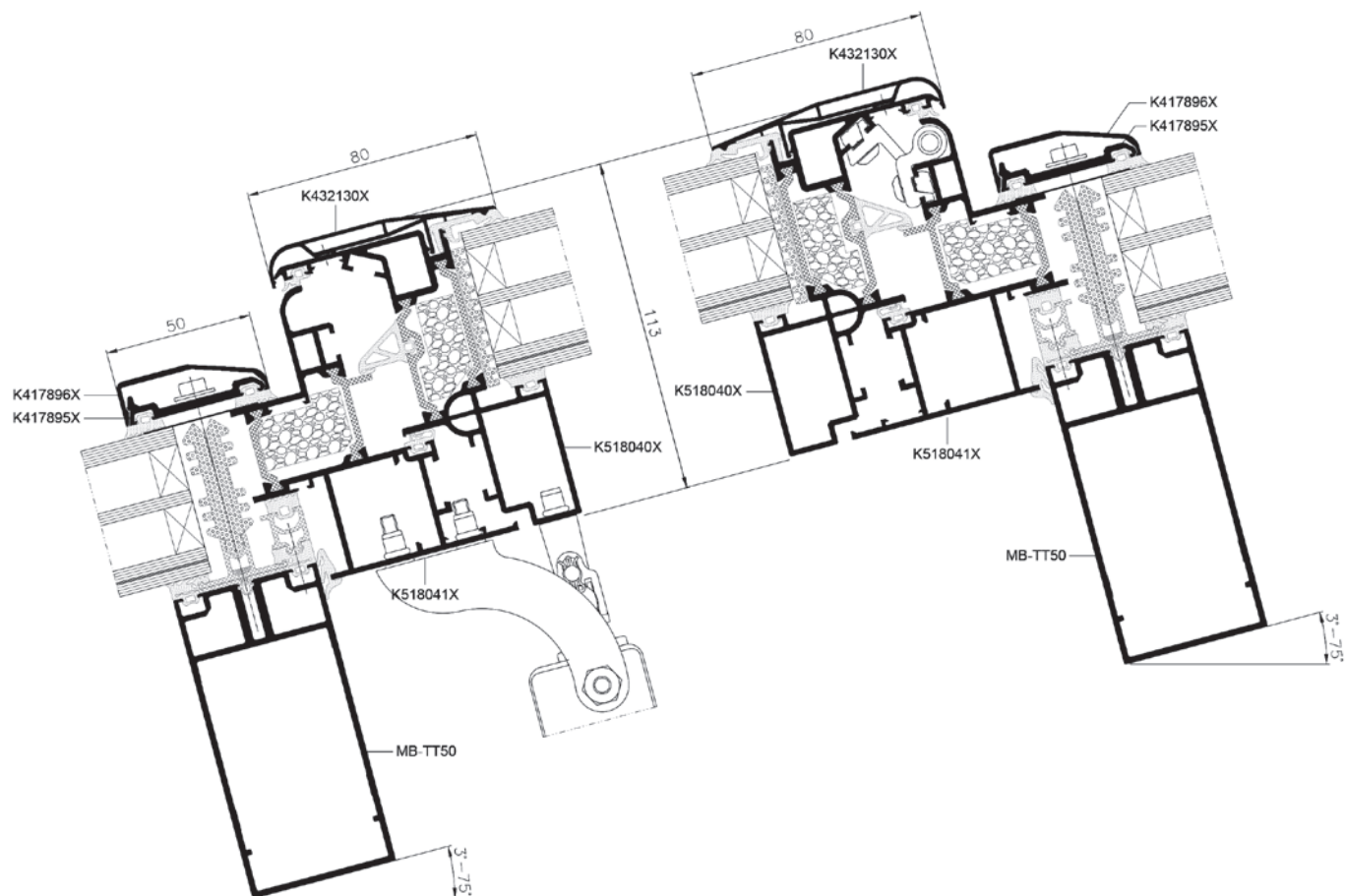
Przekrój przez okno oddymiające w systemie MB-70
