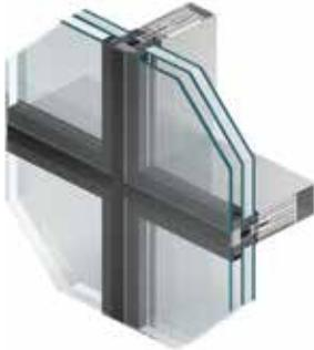
Le système MB-SR50N EI EFEKT a été conçu pour réaliser des structures coupe-feu à remplissage classées EI30, EI60. La structure de support des montants et des traverses est dotée d'un noyau spécial protégé par des inserts ignifuges. La construction peut être inclinée de  $\pm 10^\circ$  par rapport à la verticale.
