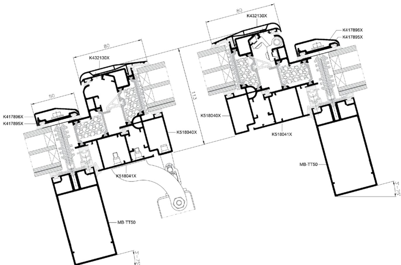
Fenêtre d'évacuation de fumées du système MB-70, vue en coupe
