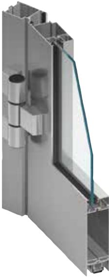
Le système MB-45 est destiné à réaliser des cloisons pare-fumée avec porte simple ou double de classe  $S_a$  et  $S_{200}$  selon la EN 13501-2:2016-07. La fonctionnalité pare-fumée est notamment conditionnée par des joints périphériques des vantaux et le placement des vitrages ou d'autres remplissages + solutions étanchéité seuil.
