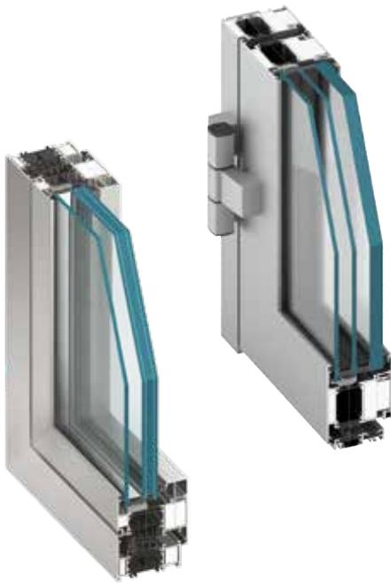
Le MB-86EI est un système de portes et de cloisons coupe-feu à isolation thermique. Il a été conçu pour être utilisé dans les structures de compartiments coupe-feu extérieures équipées de portes et de cloisons fixes ayant un classement au feu de EI1 30, EW 30 et EI 15, conformément à la norme EN 13501-2. Le MB-86EI est basé sur le système MB-86 et se caractérise par de très hautes performances thermiques et acoustiques.
