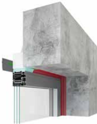
Verbindung oben, mit Dampfsperreband und mit einer Klebeversiegelung
