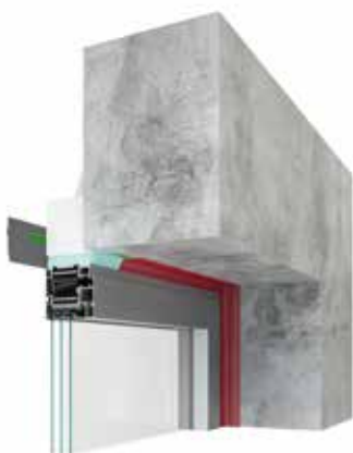
verbinding boven, met dampdicht band en lijm-afdichting
