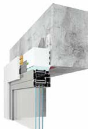
verbinding boven, met toepassing van een bovenstijlprofiel
