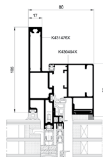
Secțiune montant-cercevea MB-SR50N IW – varianta EFEKT
