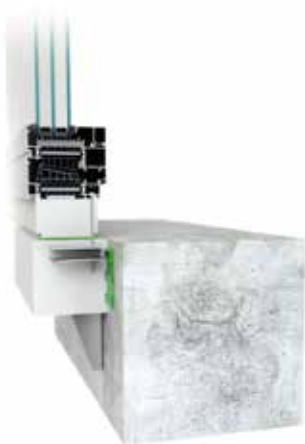
połączenie dolne, na belce 100 mm z kotwą zewnętrzną
