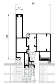
Il sistema MB-SR50N IW consente di utilizzare infissi con apertura al centro, integrati con i profili dei montanti e dei traversi. Le aree della facciata con infissi ad anta-ribalta non si differenziano, dal punto di vista dell'aspetto esterno, dalle adiacenti aree con vetrate fisse. Il sistema presenta un'elevata adattabilità grazie alle 3 versioni disponibili: standard, con listello piatto e costruzione EFEKT.
