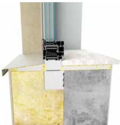
sezione della finestra installata nello strato isolante
