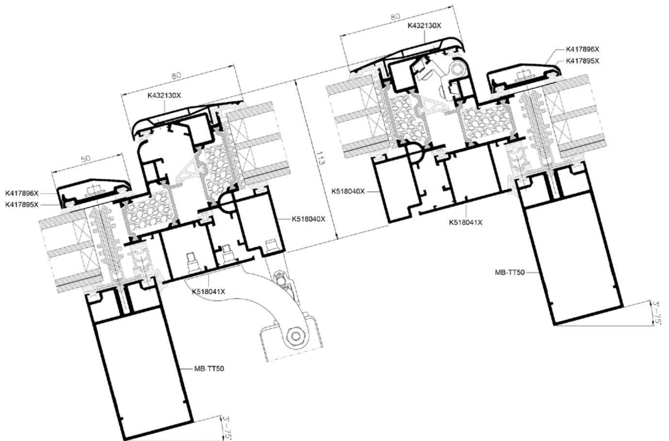
Dwarsdoorsnede door rookverwijderend raam in het systeem MB-70
