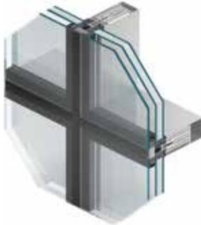
Das System MB-SR50N EI EFEKT ist für die Herstellung von feuerhemmenden EI 30- und EI 60-Füllungsprofilen bestimmt. Die Pfosten- und Riegelkonstruktion hat einen speziellen Kern, der durch brandhemmende Einlagen geschützt ist. Sie kann um einen Winkel von  $\pm 10^\circ$  zur Vertikalen geneigt werden.
