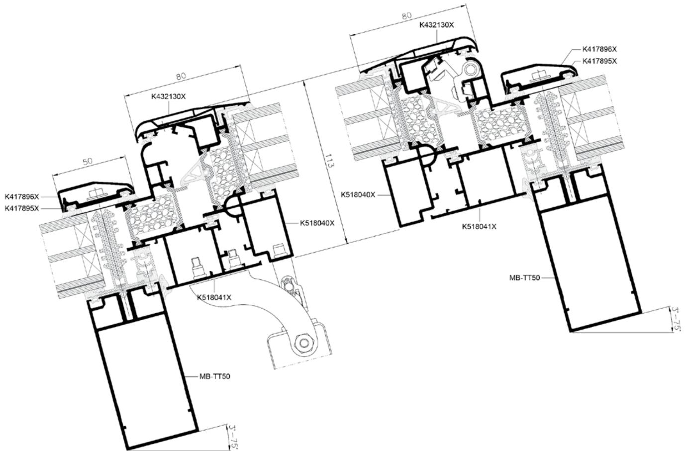
Querschnitt durch das Rauchabzugsfenster des Systems MB-70
