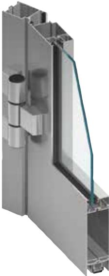
Das System MB-45 dient zur Ausführung von Trennwänden mit ein- und doppelflügeligen Rauchschutztüren der Klasse S<sub>a</sub> und S<sub>200</sub> nach EN 13501-2:2016-07. Damit die Türen ihre Funktion als Rauchschutztür erfüllen können, müssen hauptsächlich geeignete Dichtungen am Umfang der Flügel, Verglasungen oder andere Füllungen sowie Schwellendichtungen eingesetzt werden.
