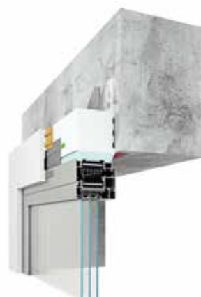
верхнє з'єднання з паронепроникною стрічкою та клеєм-ущільнювачем
