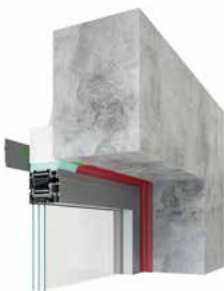
верхнє з'єднання, з застосуванням зовнішнього профілю одвірку
